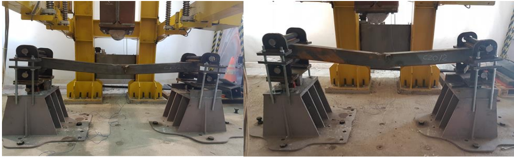
Şekil 3. C25 beton kalitesinde fiber katkısız numune Şekil 4. C25 beton kalitesinde fiber katkılı numune
